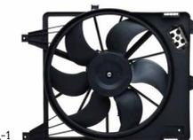
Вентилятор охлаждения в сборе с кожухом
