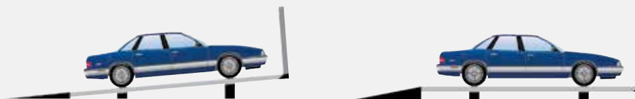
Стапель с односторонним гидравлическим подъемником
