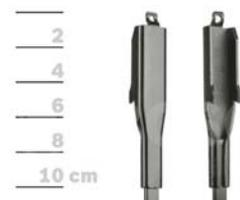
**Монтаж/Демонтаж щетки стеклоочистителя с креплением Pinch Tab**
