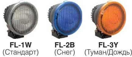
Крышки Flood — преобразуют направленный пучок света фары (10°) в рассеиваемый (40°), что уменьшает дальность свечения фары, но существенно увеличивает ширину распространения света.
