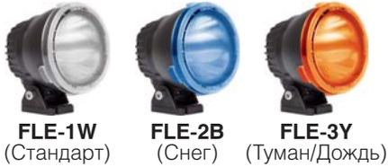
Крышки Ellipse — преобразуют направленный пучок света фары (10°) в так называемый эллиптический (30° по вертикали, 65° по горизонтали). Дальность свечения фары при этом уменьшается, но значительно увеличивается ширина распространения света, а так же, что не маловажно, подобный свет не слепит встречные автомобили.
