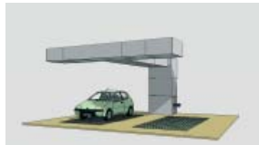
ПМ на 2 поста с вертикальным продувом, поперечным пленумом и частичным воздухообменом
