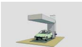
ПМ на 1 пост с вертикальным продувом, продольным пленумом и частичным воздухообменом
