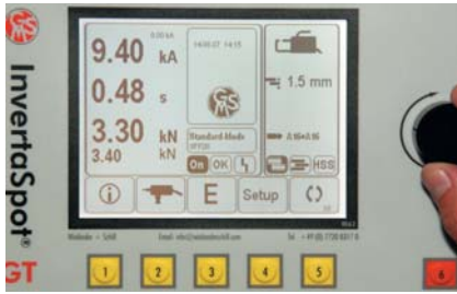
Экран отображения параметров сварки в Стандартном режиме
