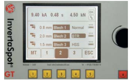
Экран Специального режима — сварка нескольких панелей разной толщины
