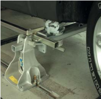
Набор адаптеров для крепления рамных автомобилей арт. 92850 Применяется совместно с Анкерной системой Wedge Clamp, арт. 92450
