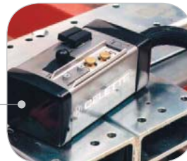
Общий пульт управления осевым подъемником и подъемным устройством для стапеля
