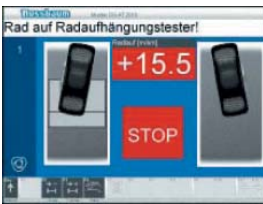
Легко понятное отображение отклонения от прямолинейного движения оси
