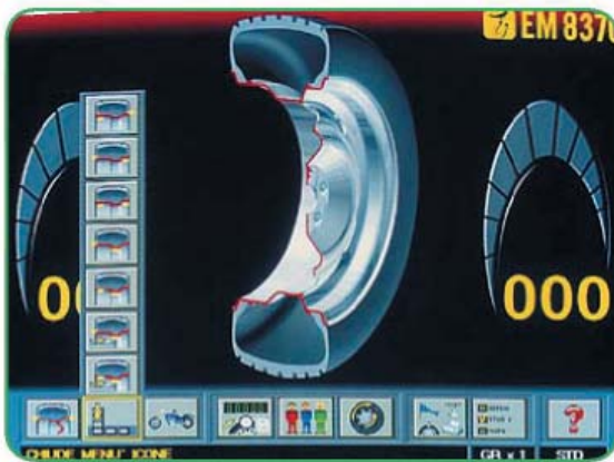
Программы ALU : –5 программ для литых дисков –2 программы для повышения точности
