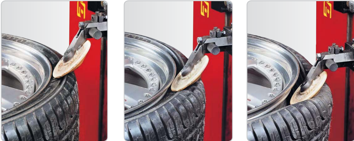
Управляемая глубина проникновения при отрыве кромки шины
