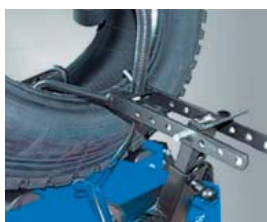
Настройка устройства расширения
