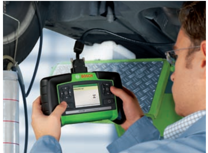
Прокачка тормозов: воздух удаляется нажатием кнопки
