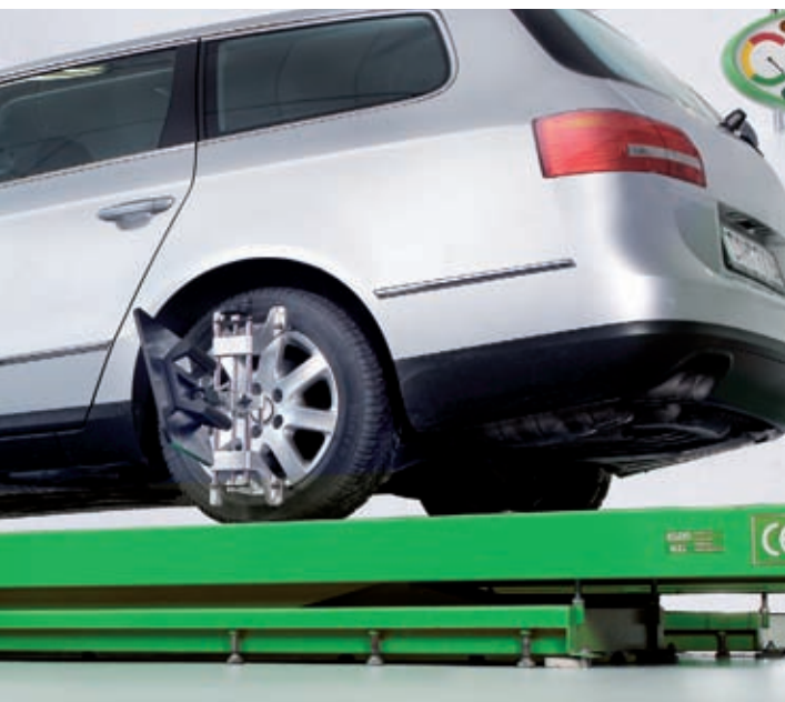
Компенсация биения дисков проездом автомобиля
