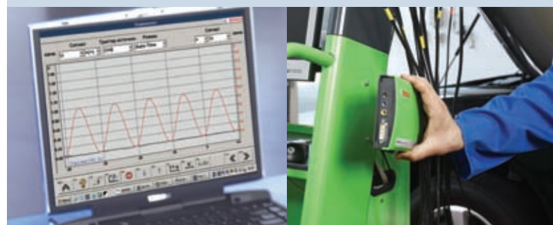
Измерения осциллографом параллельно с системной диагностикой
