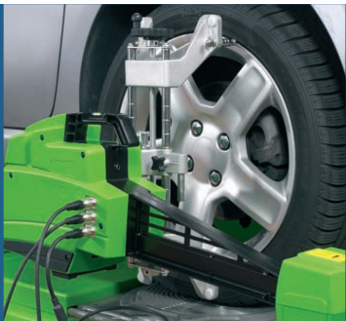
Кабельное подключение измерительной головки и электронной поворотной платы
