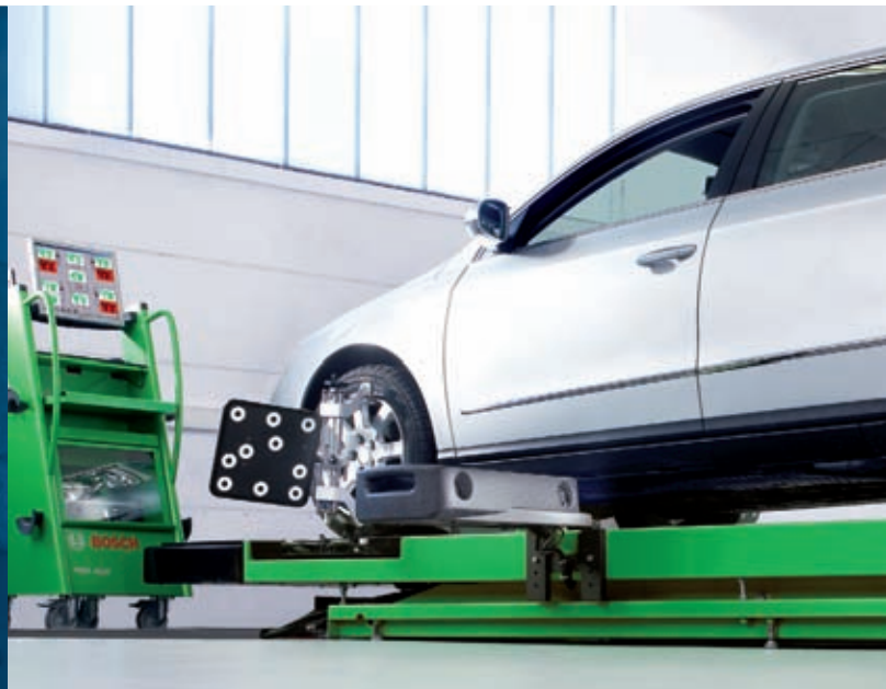
Автомобиль не обязательно поднимать или опускать для проведения измерений
